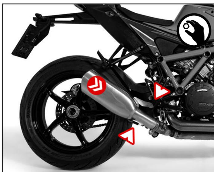
Die gesamte REMUS Anlage ausrichten und alle Verbindungen fest anziehen.
