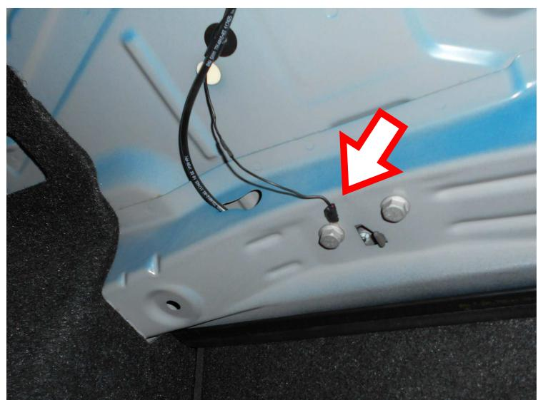
Alle entfernten Verkleidungen und Abdeckungen wieder anbringen. Das Zuleitungskabel und die Aktuatkabel am REMUS Soundcontroller anschließen. Den REMUS Soundcontroller im Bereich des Kofferraums unterbringen.
