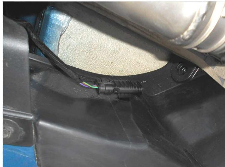
Das Hitzeschutzblech entfernen. Die Gummidichtung vom Unterboden entfernen.
