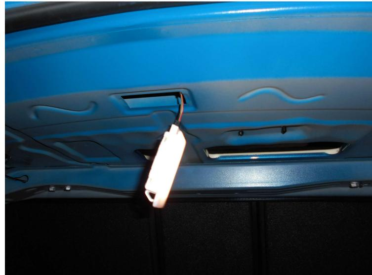
Das REMUS Zuleitungskabel hinter der Seitenverkleidung verlegen. Den rote Draht des Zuleitungskabels unter dem Fahrzeugblech bis zur herausgezogenen Kofferraumleuchte verlegen.
