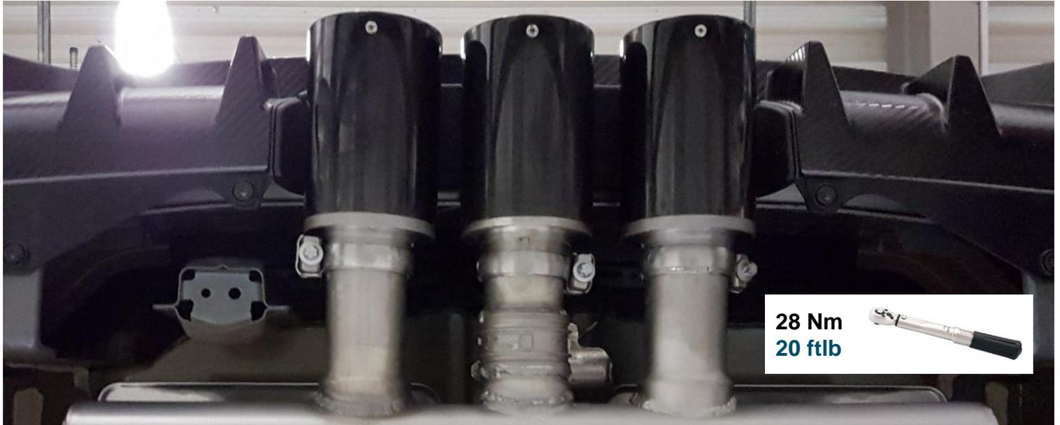
Klemm- oder Schraubverbindungen locker vorziehen. Die REMUS Abgasanlage ausrichten und die Verbindungen fest anziehen. Motor kurz anlassen und die komplette REMUS Anlage auf Dichtheit überprüfen. Sämtliche Bauteile, sowohl im kalten als auch im betriebswarmen Zustand auf Funktion und genügend Freigängigkeit überprüfen. Achten Sie dabei auf einen ausreichend belüfteten Montageraum.
