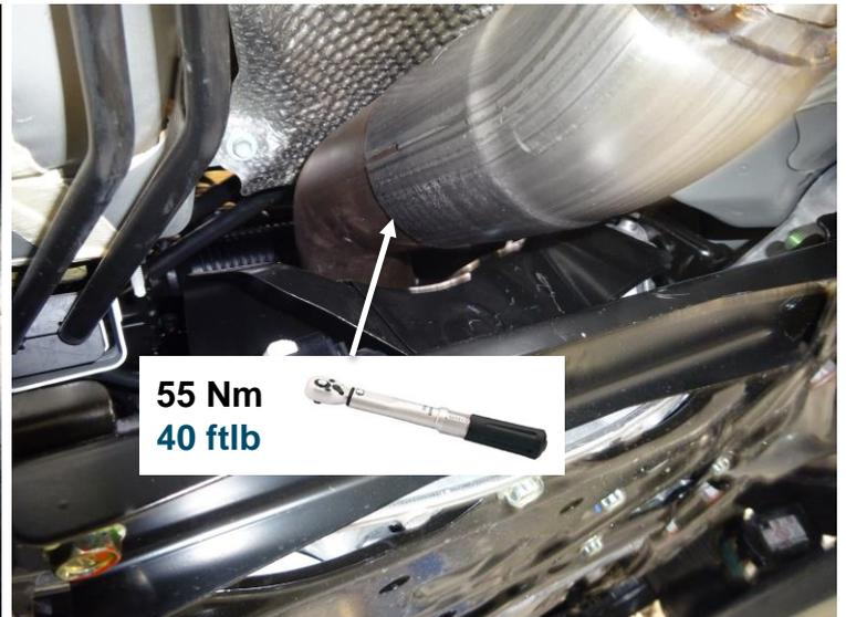
Das REMUS Mittelschalldämpferersatzrohr auf das Vorschalldämpfer aufschieben. Die Schraubverbindungen locker anziehen, um das Abgassystem noch ausrichten zu können.
