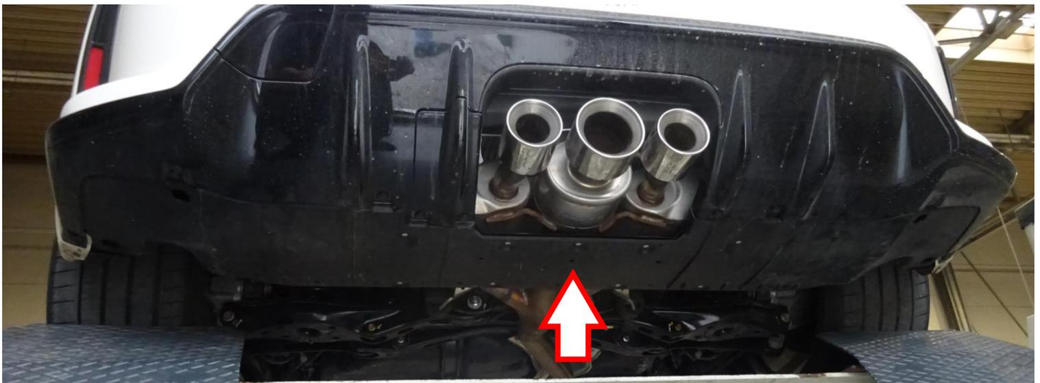
Die vordere Spritzschutzabdeckung abnehmen. Die Abgasanlage mit geeigneten Hilfsmitteln abstützen. Die Flanschverbindungen des serienmäßigen Vorrohres lösen.
