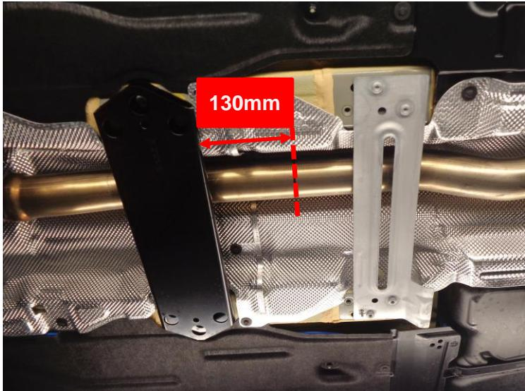
Die Querstreben demontieren. Die Aufhängungsgummis aushängen, den Aktuator abschließen und den serienmäßigen Endschalldämpfer abnehmen.
