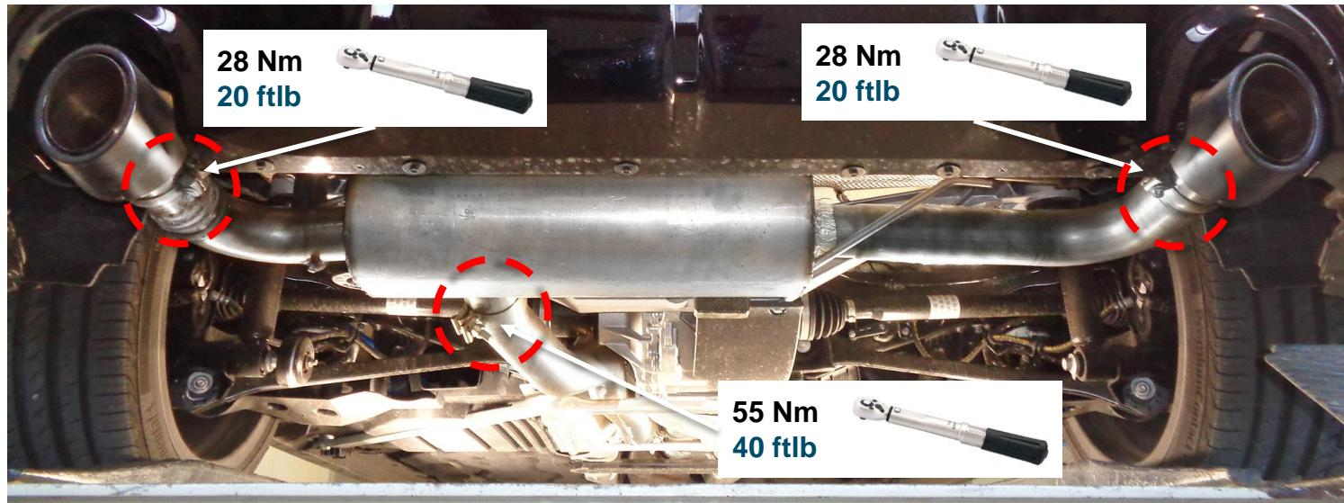
Klemm- oder Schraubverbindungen locker vorziehen. Den REMUS Sportschalldämpfer ausrichten und die Verbindungen fest anziehen. Motor kurz anlassen und den kompletten REMUS Sportschalldämpfer auf Dichtheit überprüfen. Sämtliche Bauteile, sowohl im kalten als auch im betriebswarmen Zustand auf Funktion und genügend Freigängigkeit überprüfen. Achten Sie dabei auf einen ausreichend belüfteten Montageraum.
