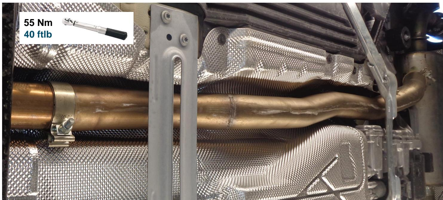
Den REMUS Sportschalldämpfer am Verbindungsrohr montieren und die Gummiaufhängungen an den Befestigungspunkten der Karosserie einhängen. Den REMUS Endrohrbogen am Sportschalldämpfer montieren. Den Aktuator anschließen, die REMUS Endrohre am REMUS Sportschalldämpfer montieren, die Querstreben wieder anbringen.
