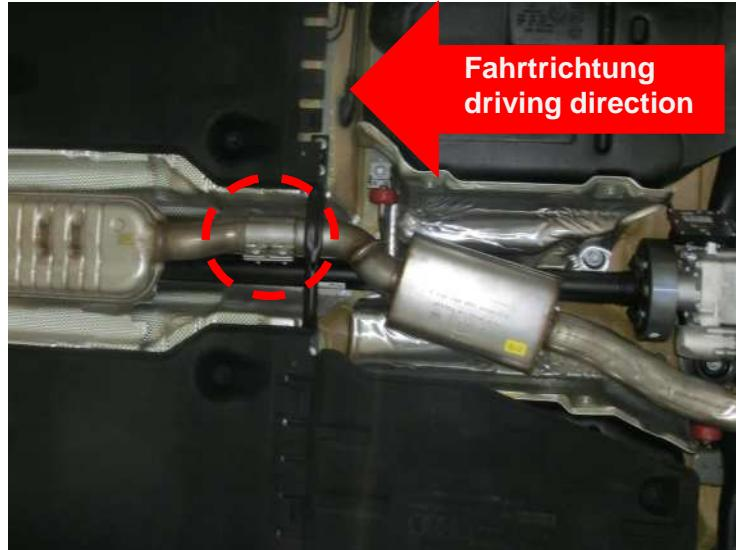
Den Aufhängungsgummi am REMUS Racingrohr montieren. Den Serienaufhängungsgummi verwenden!
