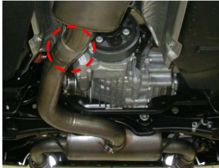
Klemm- oder Schraubverbindungen locker vorziehen. Den REMUS Sportschalldämpfer ausrichten und die Verbindungen fest anziehen. Motor kurz anlassen und den kompletten REMUS Sportschalldämpfer auf Dichtheit überprüfen. Sämtliche Bauteile, sowohl im kalten als auch im betriebswarmen Zustand auf Funktion und genügend Freigängigkeit überprüfen. Achten Sie dabei auf einen ausreichend belüfteten Montageraum.
