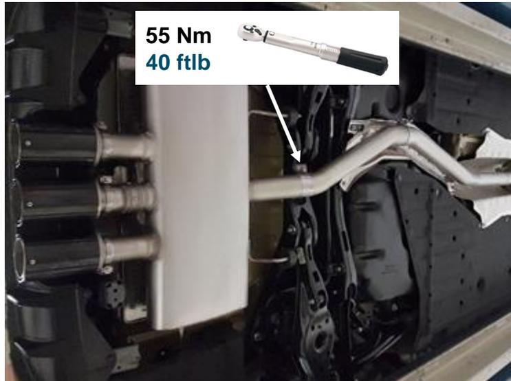
Den REMUS Sportschalldämpfer am REMUS Verbindungsrohr montieren und die Gummiaufhängungen an den Befestigungspunkten der Karosserie einhängen. Den Aktuator anschließen.
