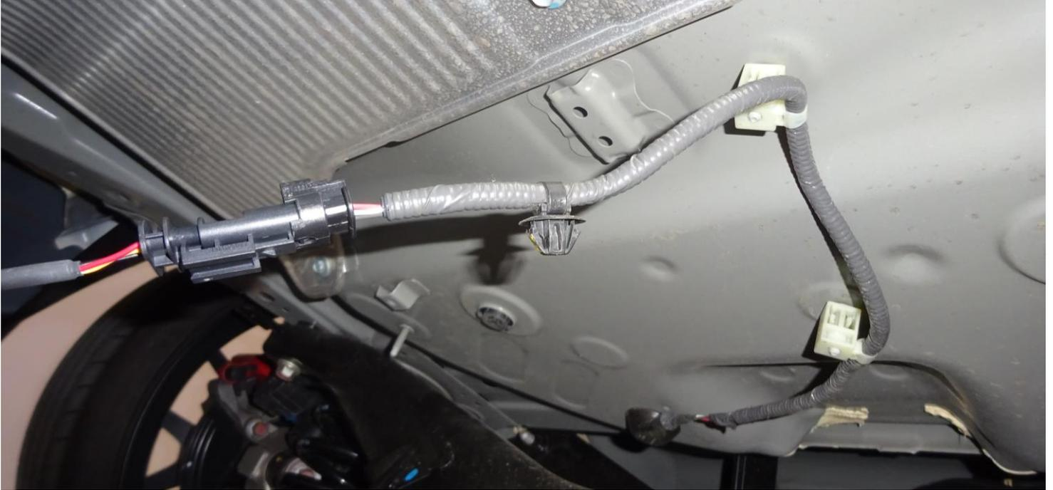
Verlegen Sie das Kabel unter der Abdeckung.
