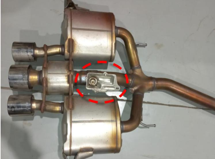
**ACHTUNG: Die Feder und der Aktuator justieren sich automatisch, passend zur Klappe, bei der ersten Fahrt!
