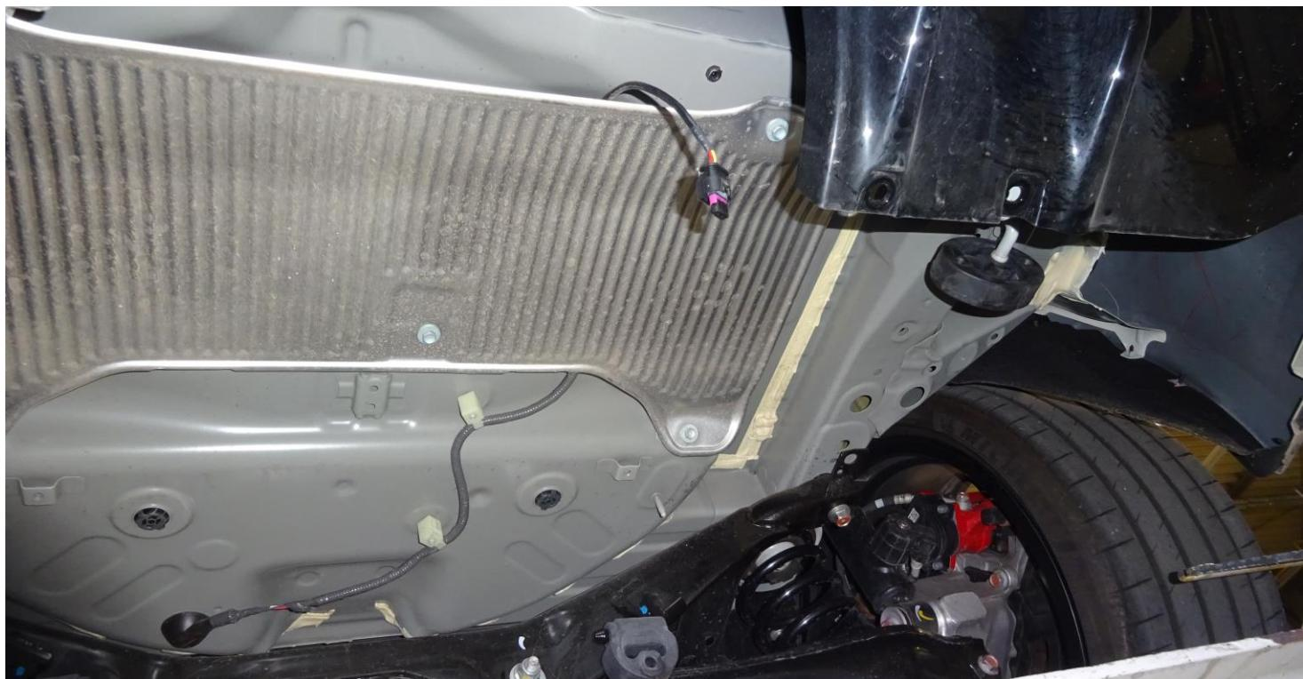
Die Aufhängungsgummis an der REMUS Abgasanlage montieren.
