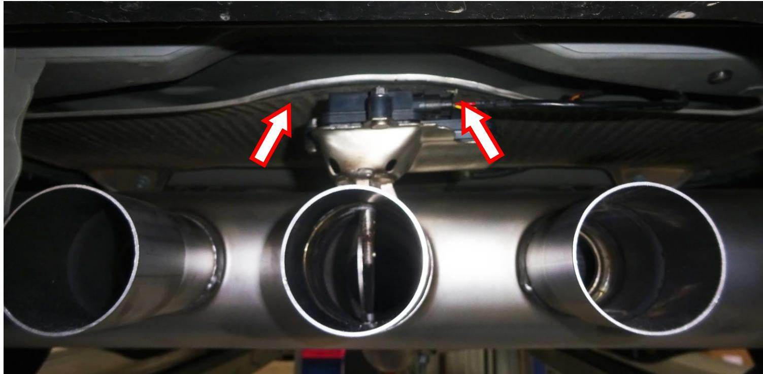
Die REMUS Endrohre am REMUS Sportschalldämpfer montieren und die gesamte REMUS Abgasanlage ausrichten.
