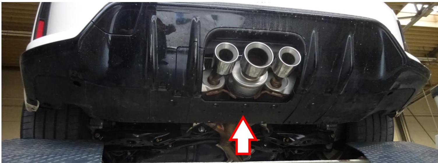
Die serienmäßige Abgasanlage mit geeigneten Hilfsmitteln abstützen. Die Flanschverbindung nach dem Serienvorschalldämpfer lösen.
