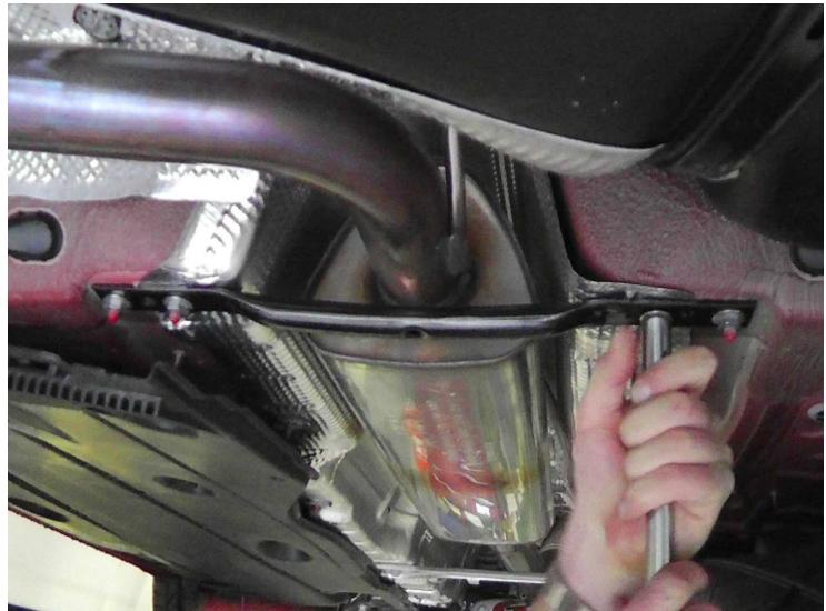
Die serienmäßige Abgasanlage mit geeigneten Hilfsmitteln abstützen. Schellenverbindung zwischen Vorschalldämpfer und Katalysator lösen. Die Aufhängungsgummis aushängen und die serienmäßige Abgasanlage abnehmen.
