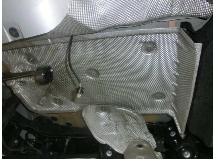
Den REMUS Sportschalldämpfer laut Montageanleitung montieren. Entfernen Sie die Schraube und das dahinter liegende Befestigungsblech, um die Funktion der Klappe herzustellen.
