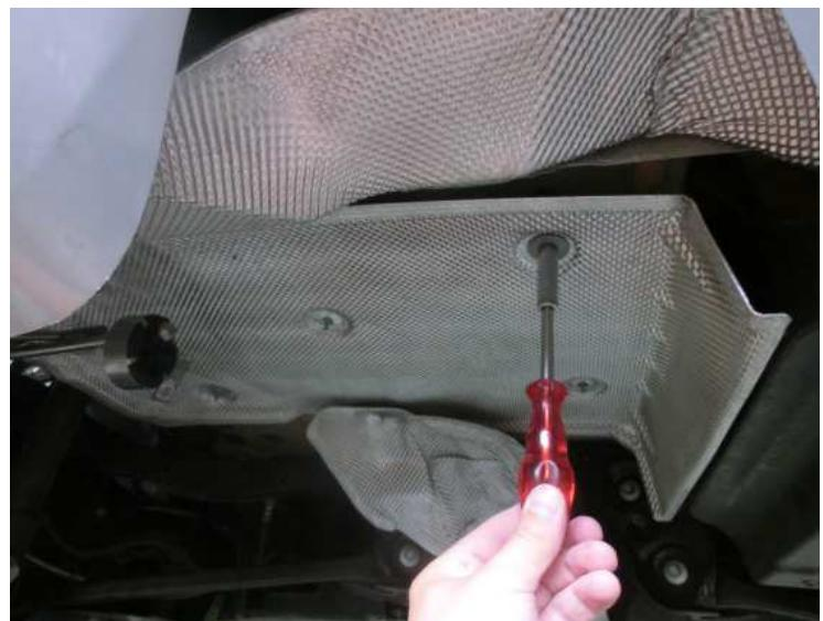
Die Kunststoffabdeckung unter dem Hitzeschutzblech lösen.
