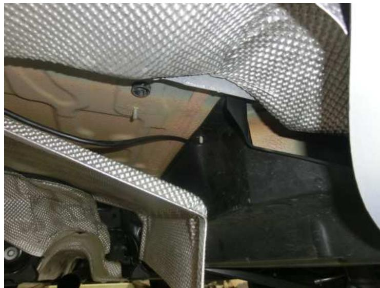
Entfernen Sie den Ringkabelschuh vom Zuleitungskabel.
