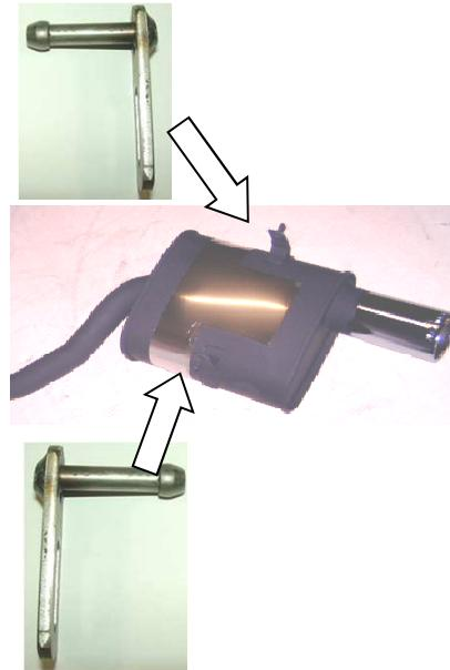
Den REMUS Sportschalldämpfer auf die durchtrennten serienmäßigen Rohre aufschieben und die Gummiaufhängungen an den Befestigungspunkten der Karosserie einhängen.
