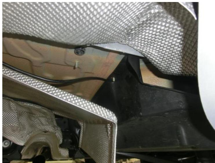
Entfernen Sie den Ringkabelschuh vom Zuleitungskabel.
