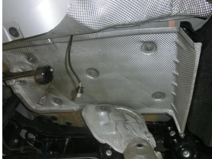
Entfernen Sie den Schweißpunkt und die Schraube(n) des Befestigungsbleches und entfernen Sie die Klappensicherung um die Funktion der Klappe herzustellen. Den Aktuator an der Klappe des Endschalldämpfers montieren. Die Klappensicherung kann sich je nach Ausführung unterscheiden.
