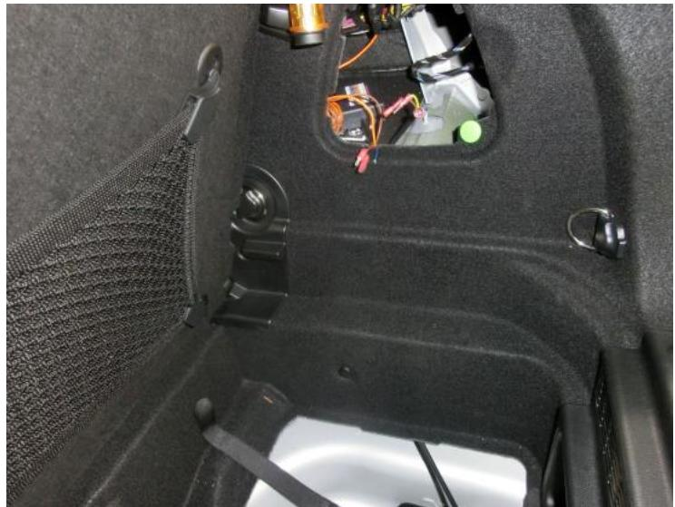
Mit Hilfe der mitgelieferten Schwachstromverbinder die Kabel (rotes Kabel auf "+" der Steckdose und schwarzes Kabel auf "-") mit dem Bordnetz verbinden.
