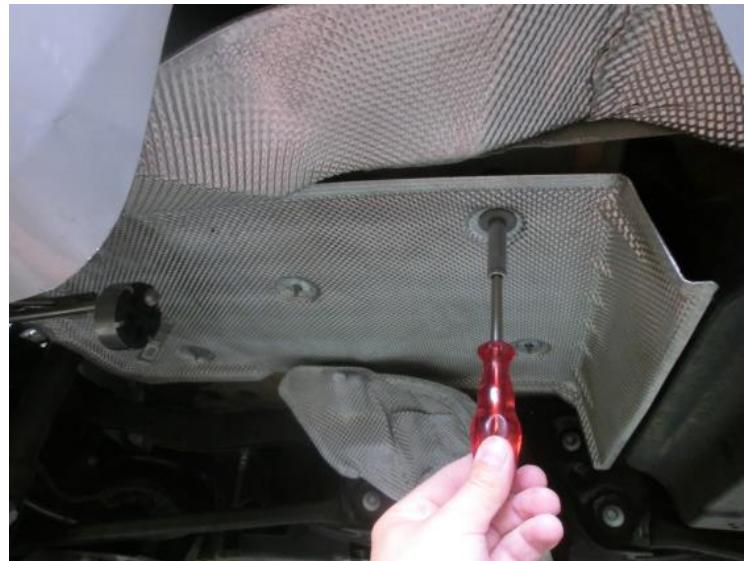
Die Kunststoffabdeckung unter dem Hitzeschutzblech lösen.
