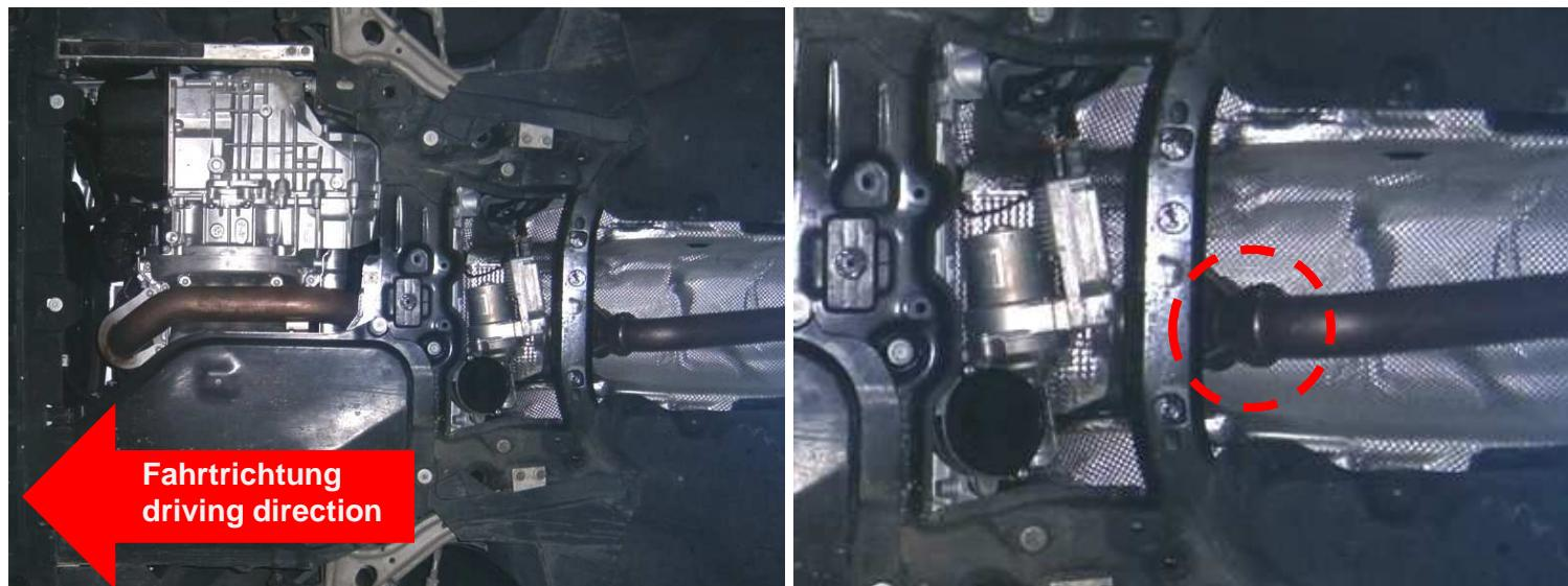
Die Querstreben entfernen. Die Aufhängungsgummis aushängen und die serienmäßige Abgasanlage abnehmen.
