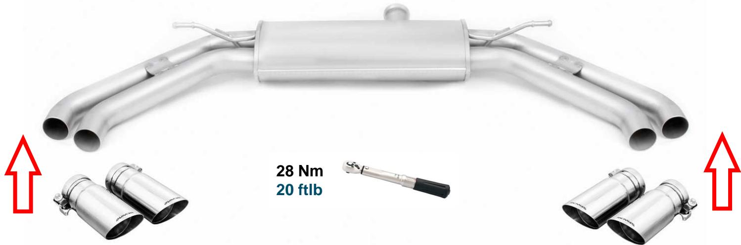
Klemm- oder Schraubverbindungen locker vorziehen. Den REMUS Sportschalldämpfer ausrichten und die Verbindungen fest anziehen. Motor kurz anlassen und den kompletten REMUS Sportschalldämpfer auf Dichtheit überprüfen. Sämtliche Bauteile, sowohl im kalten als auch im betriebswarmen Zustand auf Funktion und genügend Freigängigkeit überprüfen. Achten Sie dabei auf einen ausreichend belüfteten Montageraum.
