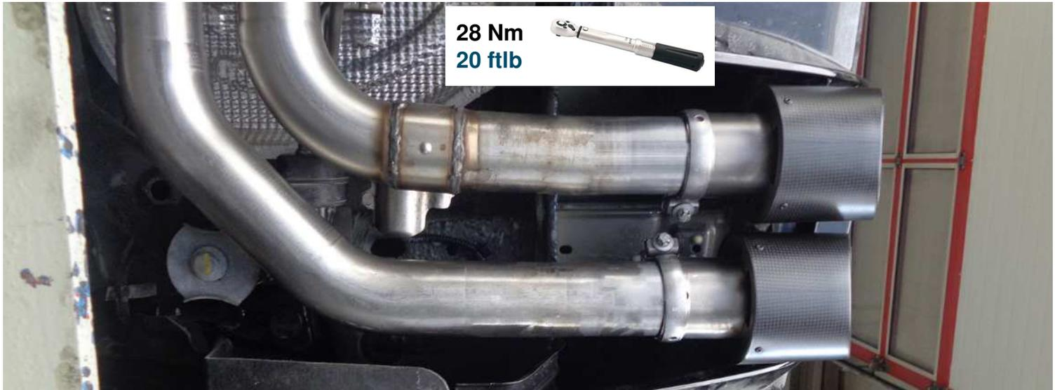
Klemm- oder Schraubverbindungen locker vorziehen. Den REMUS Sportschalldämpfer ausrichten und die Verbindungen fest anziehen. Motor kurz anlassen und den kompletten REMUS Sportschalldämpfer auf Dichtheit überprüfen. Sämtliche Bauteile, sowohl im kalten als auch im betriebswarmen Zustand auf Funktion und genügend Freigängigkeit überprüfen. Achten Sie dabei auf einen ausreichend belüfteten Montageaum.
