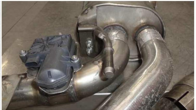
Die REMUS Verbindungsrohre auf das serienmäßige Rohr aufschieben. Den REMUS Sportschalldämpfer am Verbindungsrohr montieren und die Gummiaufhängungen an den Zusatzhaltern einhängen. Die Aktuatoren anschließen.
