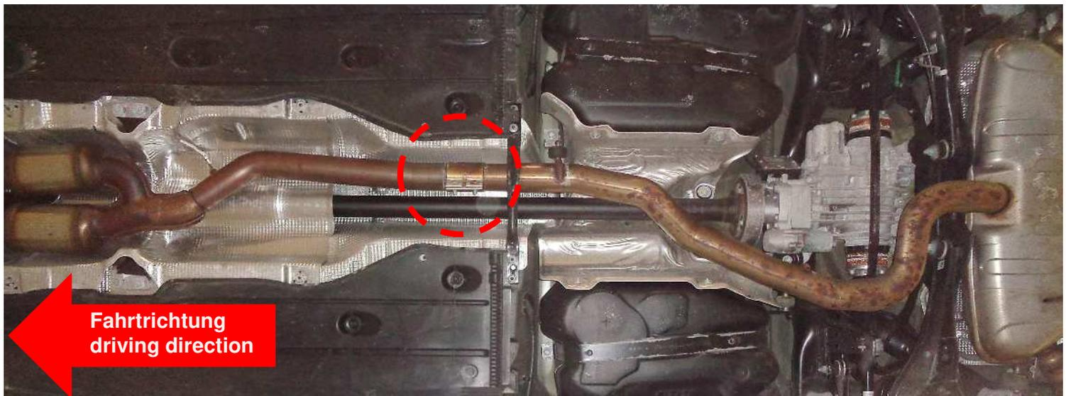
Die Aufhängungsgummis am Rohrbogen aushängen und die Aktuatoren abschließen. Die Karosseriehalter des serienmäßigen Endschalldämpfers abschrauben und den Endschalldämpfer abnehmen.
