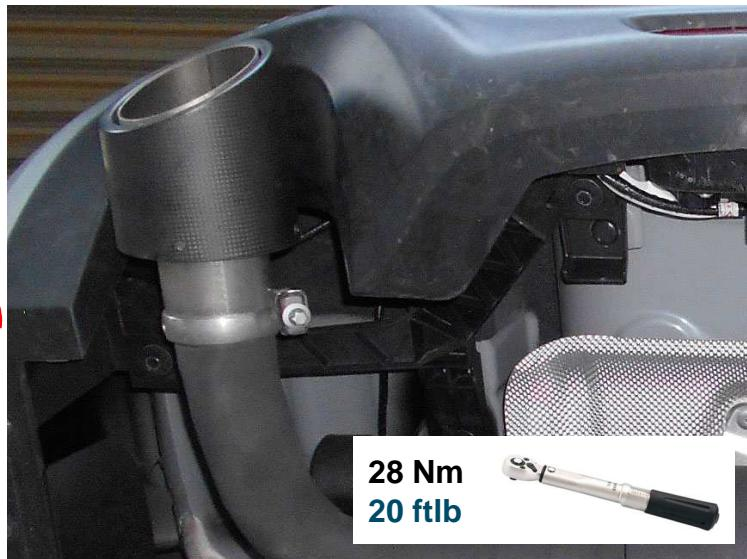
Klemm- oder Schraubverbindungen locker vorziehen. Den REMUS Sportschalldämpfer ausrichten und die Verbindungen fest anziehen. Motor kurz anlassen und den kompletten REMUS Sportschalldämpfer auf Dichtheit überprüfen. Sämtliche Bauteile, sowohl im kalten als auch im betriebswarmen Zustand auf Funktion und genügend Freigängigkeit überprüfen. Achten Sie dabei auf einen ausreichend belüfteten Montageraum.
