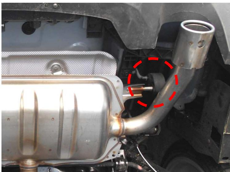
Die Aufhängungsgummis am Sportschalldämpfer montieren. Den REMUS Sportschalldämpfer am Serienflansch montieren und die Gummiaufhängungen an den Befestigungspunkten der Karosserie einhängen.
