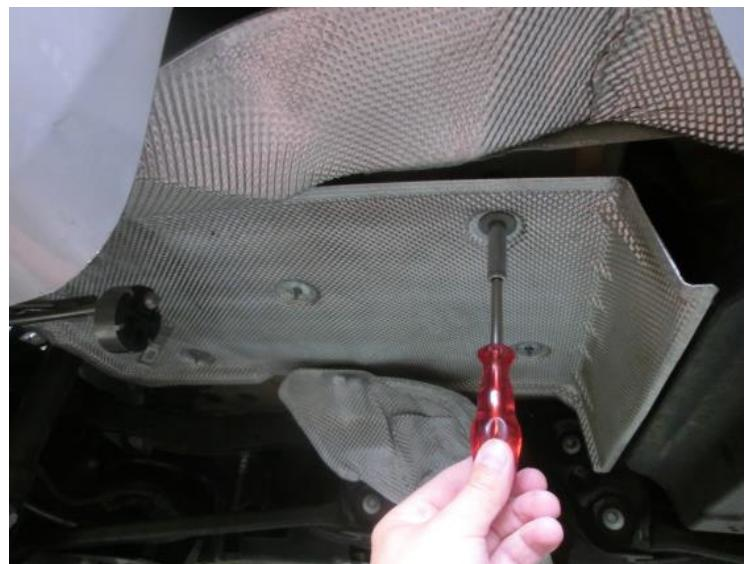
Die Kunststoffabdeckung unter dem Hitzeschutzblech lösen.
