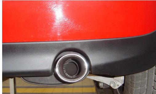
Klemm- oder Schraubverbindungen locker vorziehen. Den REMUS Sportschalldämpfer ausrichten und die Verbindungen fest anziehen. Motor kurz anlassen und den kompletten REMUS Sportschalldämpfer auf Dichtheit überprüfen. Sämtliche Bauteile, sowohl im kalten als auch im betriebswarmen Zustand auf Funktion und genügend Freigängigkeit überprüfen. Achten Sie dabei auf einen ausreichend belüfteten Montageraum.
