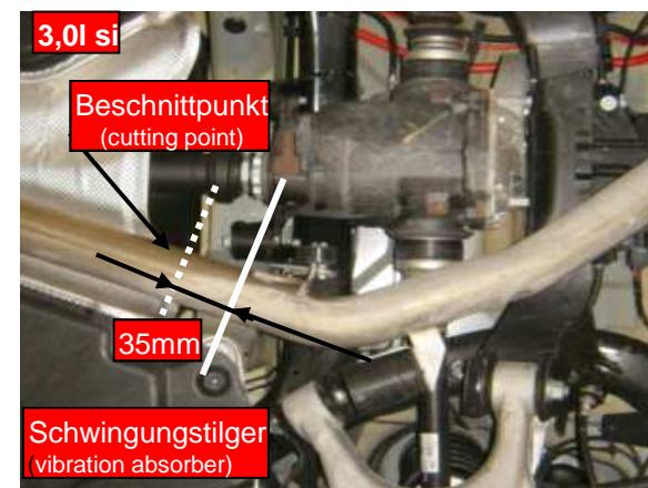
Das Masseband und den Schwingungstilger demontieren (wenn vorhanden). Die Aufhängungsgummis aushängen und den serienmäßigen Endschalldämpfer abnehmen. Trennstellen entgraten.
