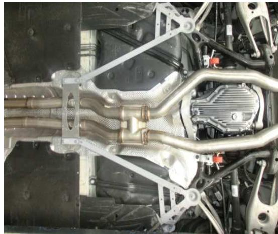
Den REMUS Sportschalldämpfer auf das Ersatzrohr montieren, alternativ den Serienendschalldämpfer wieder montieren. Bei Montage des Serienendschalldämpfers muss die Anlage beschnitten werden.
