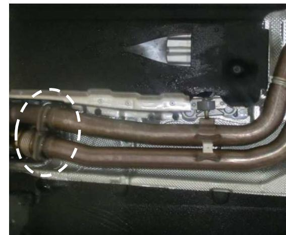
Die Aufhängungsgummis aushängen, die Aktuatoren des Endschalldämpfers abschließen und die serienmäßige Abgasanlage abnehmen. (Abb. 3) Die Aufhängungsgummis am REMUS Sportschalldämpfer montieren.
