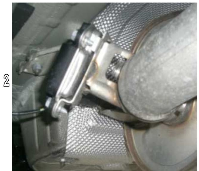
Die Aufhängungsgummis aushängen und den serienmäßigen Endschalldämpfer abnehmen. (Abb. 3) Trennstelle entgraten.
