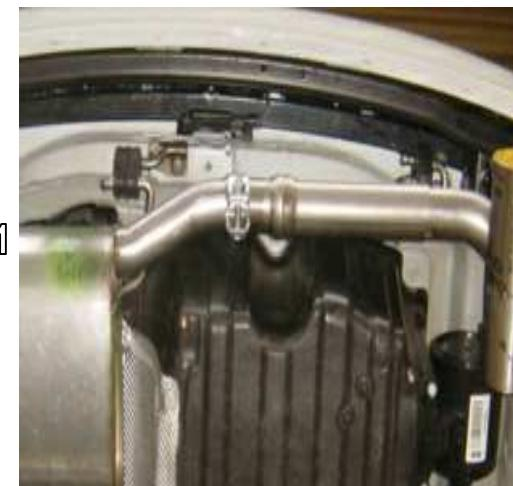
Klemm- oder Schraubverbindungen locker vorziehen. Den REMUS Sportschalldämpfer ausrichten und die Verbindungen fest anziehen. Motor kurz anlassen und den kompletten REMUS Sportschalldämpfer auf Dichtheit überprüfen. Sämtliche Bauteile, sowohl im kalten als auch im betriebswarmen Zustand auf Funktion und genügend Freigängigkeit überprüfen. Achten Sie dabei auf einen ausreichend belüfteten Montageraum.
