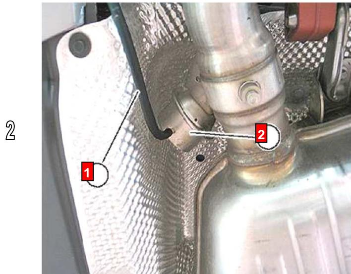
Die Aufhängungsgummis samt Halter demontieren und den serienmäßigen Endschalldämpfer abnehmen. Trennstellen entgraten.
