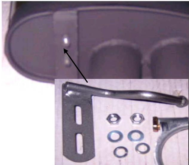
Die Aufhängungsgummis samt Halter von den Serienschalldämpfern an den Zusatzhaltern des REMUS Sportschalldämpfers montieren.
