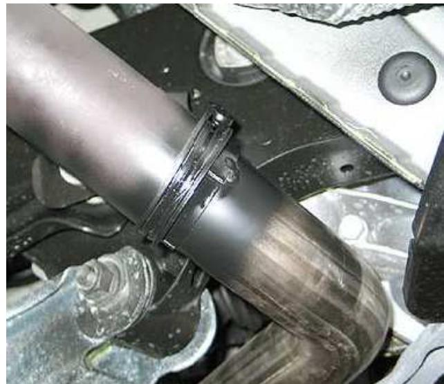
Klemm- oder Schraubverbindungen locker vorziehen. Den REMUS Sportschalldämpfer ausrichten und die
