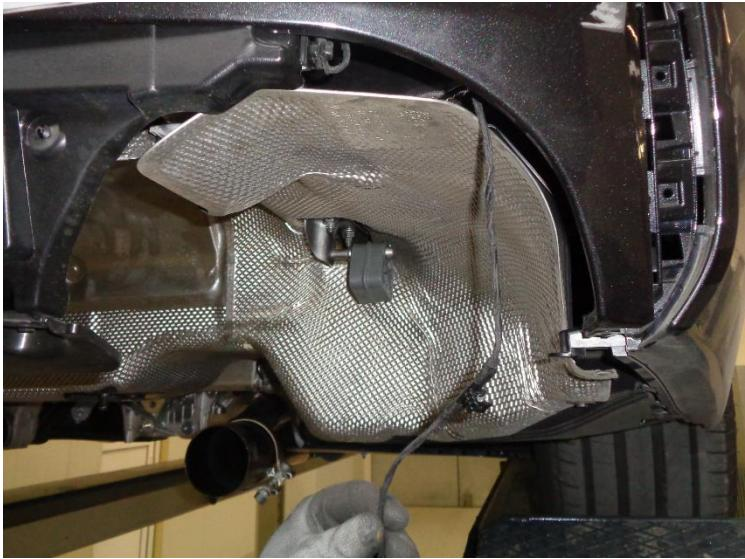
Das Aktuatorkabel unter dem Hitzeschutzblech verlegen und mit Hilfe der Klammer am Hitzeschutzblech fixieren.
