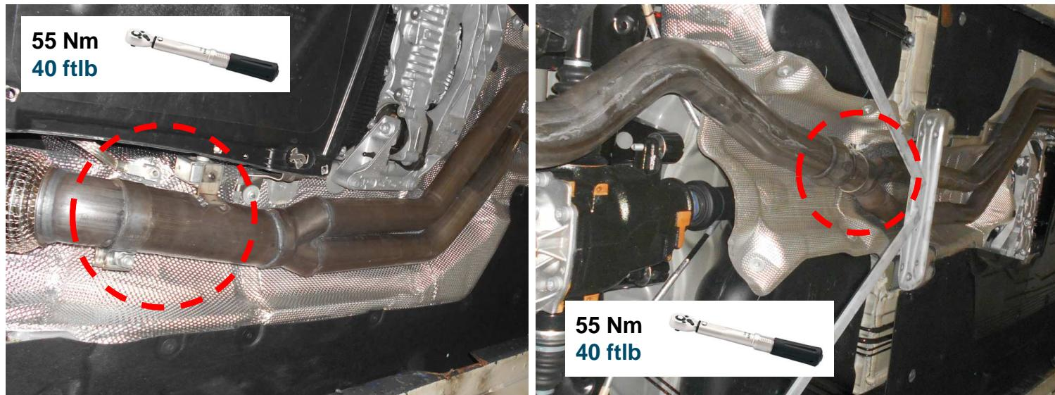
Den REMUS Sportschalldämpfer auf den REMUS Vorschalldämpfer aufschieben, alternativ den Serienendschalldämpfer verwenden. Bei Montage des Serienendschalldämpfers muss die Anlage beschnitten werden. **Schnittpunkt = Kerbe**
