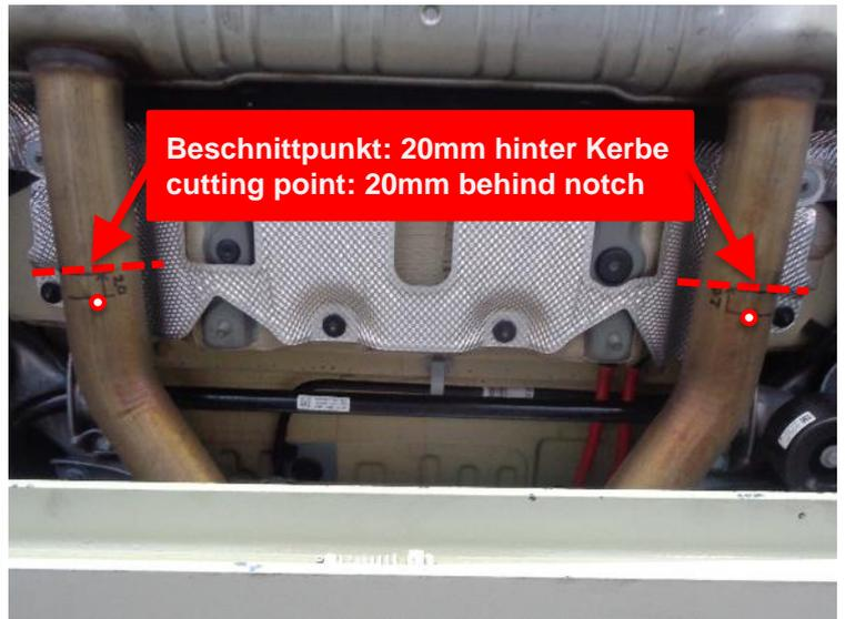
Die Aktuatoren abschließen, Aufhängungsgummis aushängen und den serienmäßigen Endschalldämpfer abnehmen.
