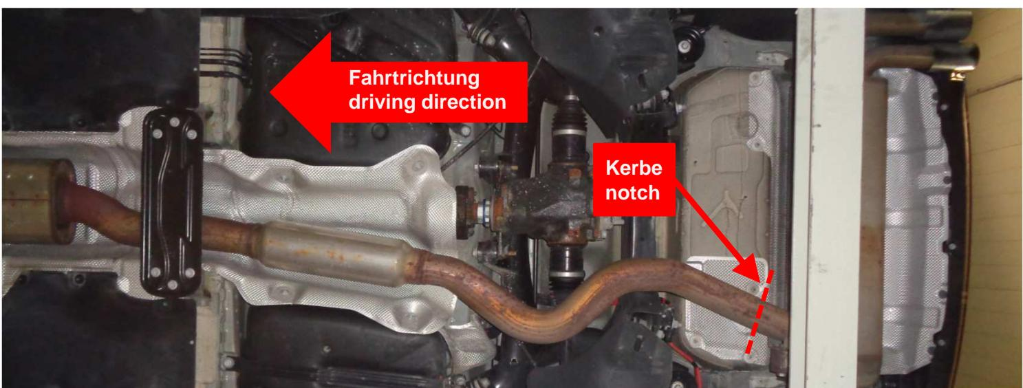
Den Aktuator abschließen und von der Halterung des Endschalldämpfers demontieren. Die Aufhängungsgummis aushängen und den serienmäßigen Endschalldämpfer abnehmen.
