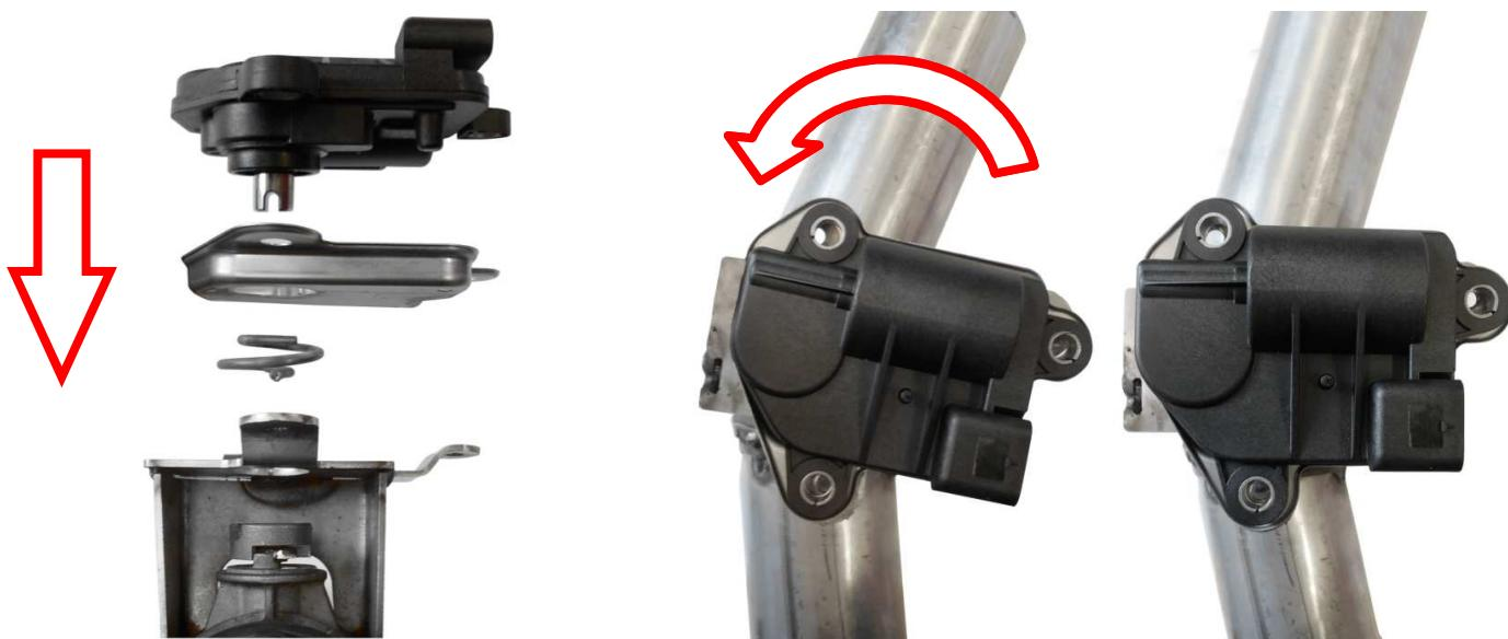
Den linken und rechten REMUS Endrohrbogen am REMUS Sportschalldämpfer montieren. Den Aktuator anschließen.
