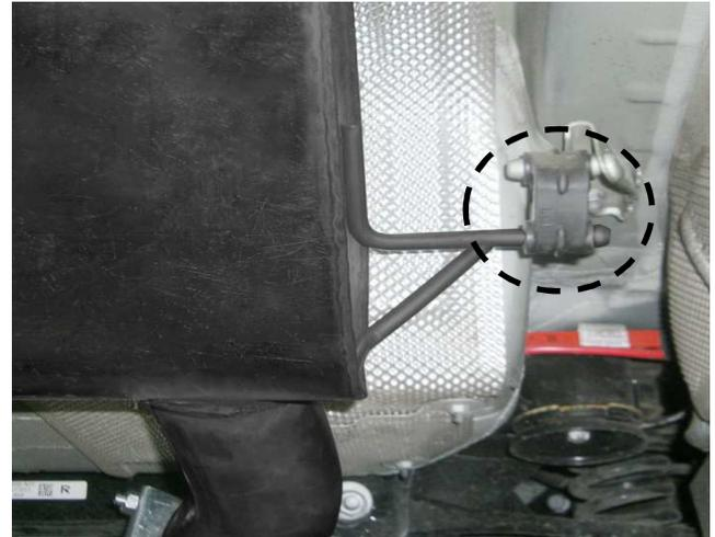
Den Aktuator der serienmäßigen Klappensteuerung an der dafür vorgesehenen Halterung am REMUS Sportschalldämpfer montieren.
