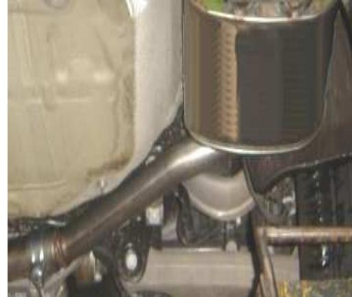
Klemm- oder Schraubverbindungen locker vorziehen. Den REMUS Sportschalldämpfer ausrichten und die Verbindungen fest anziehen. Motor kurz anlassen und den kompletten REMUS Sportschalldämpfer auf Dichtheit überprüfen. Sämtliche Bauteile, sowohl im kalten als auch im betriebswarmen Zustand auf Funktion und genügend Freigängigkeit überprüfen. Achten Sie dabei auf einen ausreichend belüfteten Montageraum.
