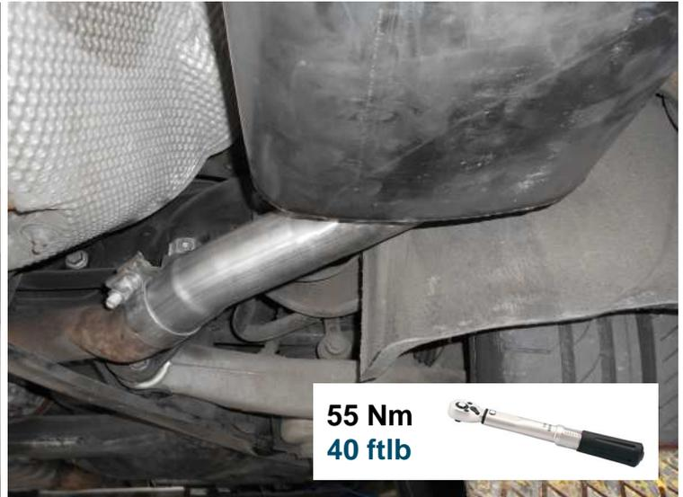
Die Gummiaufhängungen an den Befestigungspunkten der Karosserie einhängen. Die Aktuatoren des REMUS Sportschalldämpfer anschließen.
