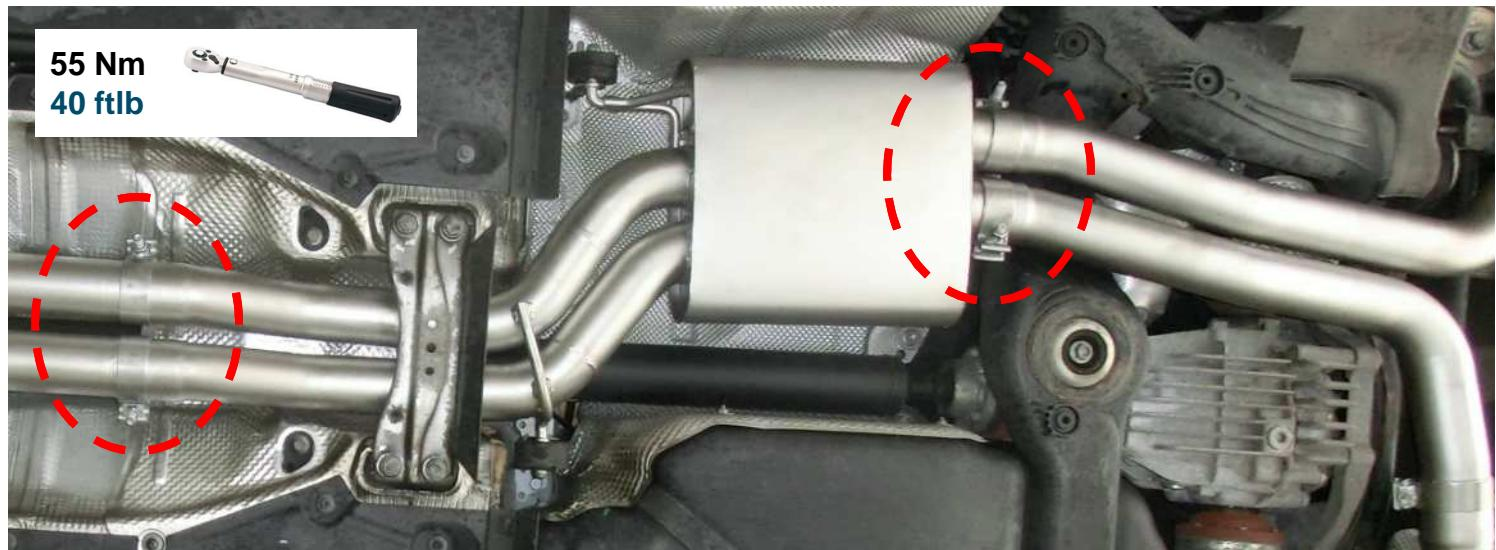
Die Querstrebewie wieder montieren. Die REMUS Sportschalldämpfer an den Verbindungsrohren montieren.
