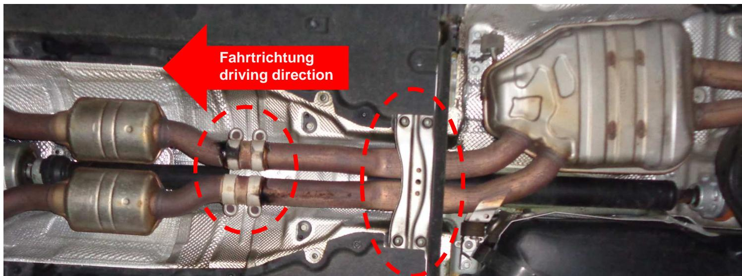
Die Aktuatoren abschließen, die Aufhängungsgummis aushängen und die Serienabgasanlage abnehmen.
