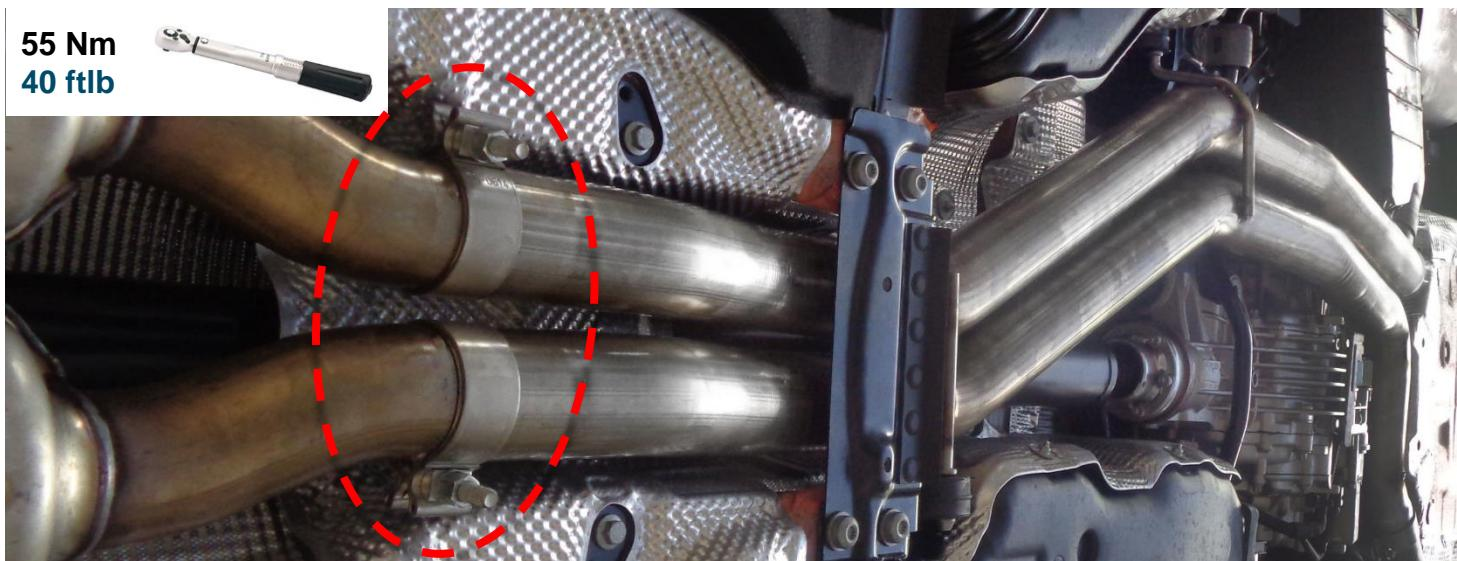
Die Aktuatoren und die Hitzeschutzbüchse der Serienendschalldämpfer demontieren und auf die REMUS Schalldämpfer montieren.
