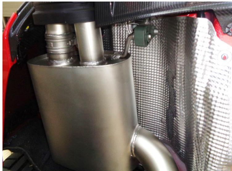
Die REMUS Endrohre auf die REMUS Sportschalldämpfer aufschieben, ausrichten und montieren. Die Querstrebbe wieder montieren.
