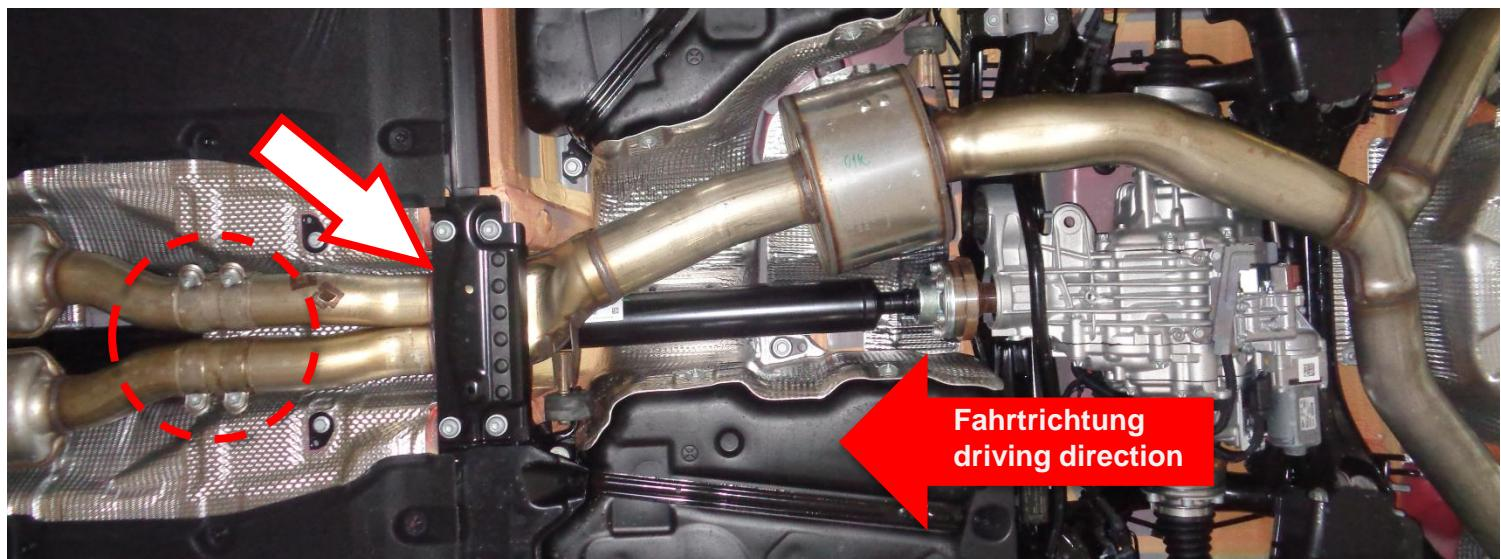
Die Aufhängungsgummis aushängen, die Aktuatoren der Endschalldämpfer abschließen und die serienmäßige Abgasanlage abnehmen.
