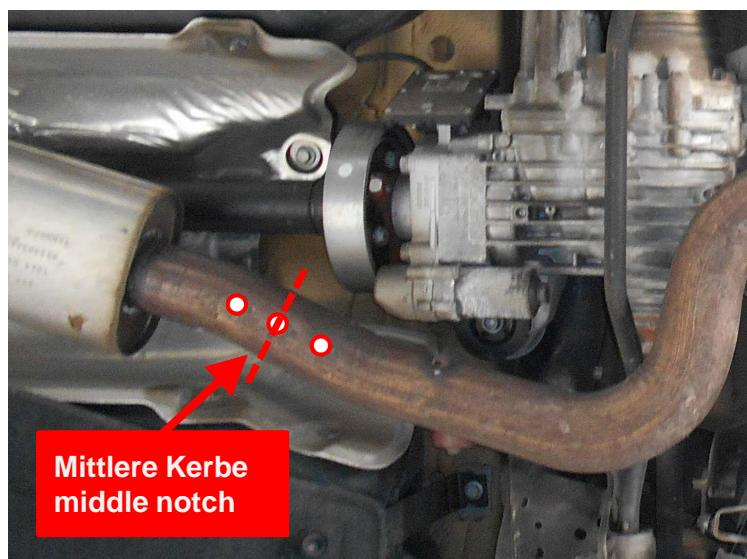
Die Aktuatoren abschließen, die Aufhängungsgummis aushängen und den serienmäßigen Endschalldämpfer abnehmen.
