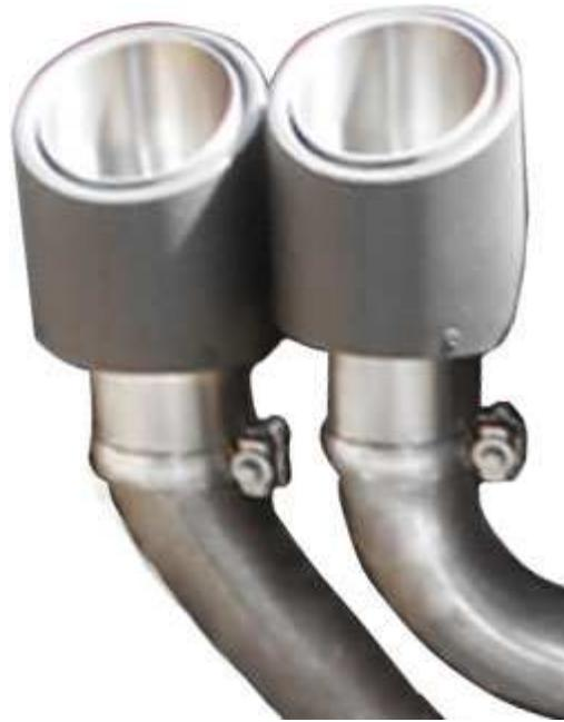
Klemm- oder Schraubverbindungen locker vorziehen. Den REMUS Sportschalldämpfer ausrichten und die Verbindungen fest anziehen. Motor kurz anlassen und den kompletten REMUS Sportschalldämpfer auf Dichtheit überprüfen. Sämtliche Bauteile, sowohl im kalten als auch im betriebswarmen Zustand auf Funktion und genügend Freigängigkeit überprüfen. Achten Sie dabei auf einen ausreichend belüfteten Montageraum.
