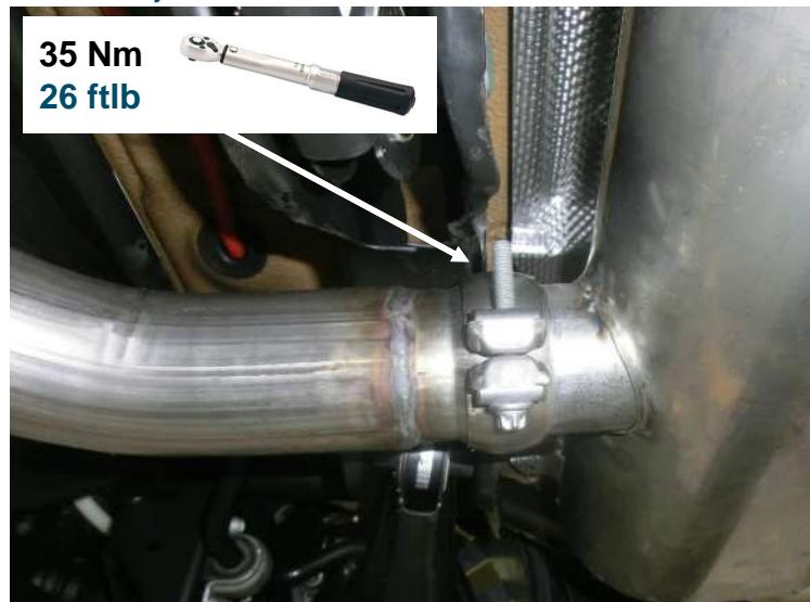
Die REMUS Endrohrbögen auf den REMUS Sportschalldämpfer aufschieben. Die Aktuatoren vom Serienendschalldämpfer abnehmen, am REMUS Sportschalldämpfer montieren und anschließen.
